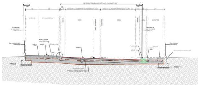
Le rampe per l'accesso al sottopasso stradale hanno una pendenza max del 6%, quella a sud, e dell'8% quella a nord, mentre quelle dei percorsi ciclo-pedonali presentano una pendenza inferiore all'8% con pianerottoli orizzontali ogni 10 m, compatibile con la normativa per il superamento delle barriere architettoniche.
