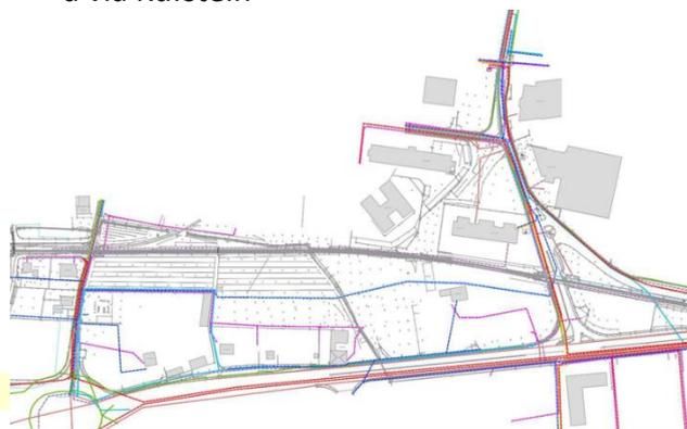
Il progetto prevede un nuovo tracciato stradale che, a partire dalla rotatoria sulla SS12, adegua il tratto iniziale di Via Palazzine, corre parallelamente alla ferrovia, la supera con un sottopasso e si collega alla zona produttiva con una nuova rotatoria fra Via di Spini, Via Ora del Garda e Via Kufstein
