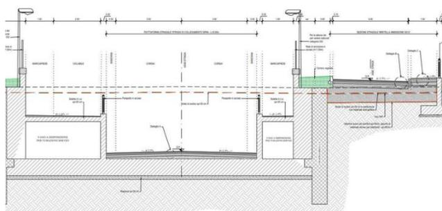
Le rampe per l'accesso al sottopasso stradale hanno una pendenza max del 6%, quella a sud, e dell'8% quella a nord, mentre quelle dei percorsi ciclo-pedonali presentano una pendenza inferiore all'8% con pianerottoli orizzontali ogni 10 m, compatibile con la normativa per il superamento delle barriere architettoniche.
