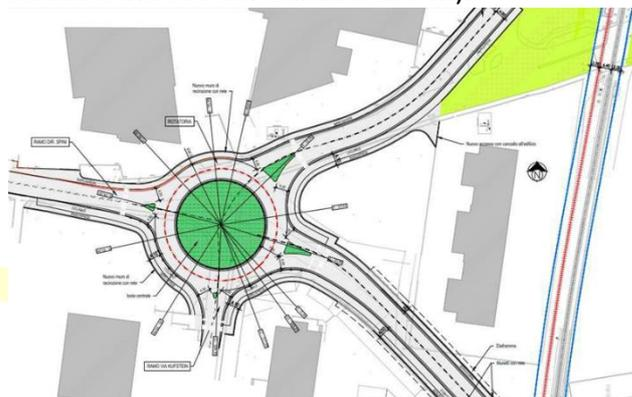
La nuova rotatoria è realizzata in corrispondenza dell'intersezione fra la nuova strada di collegamento all'area produttiva, via di Spini, via dell'Ora del Garda e via Kufstein. Essa ha un diametro interno di 16 m, una larghezza della corsia pari a 8,00 m e l'area interna ha una sistemazione a verde
